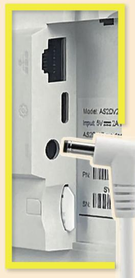
Der Netzstecker ist in der Regel bereits im Gerät eingesteckt. Ansonsten stecken Sie den Netzstecker in die Geräte-Buchse (siehe Abb. links) und das Netzteil in eine nahe Steckdose. Damit haben Sie jetzt alle wichtigen Vorbereitungen getroffen und die automatische Installation kann beginnen.
